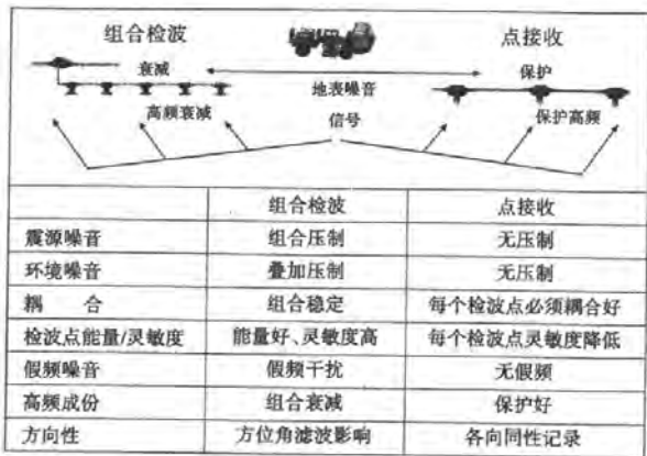
图 6a 组合检波与点接收性能对比
