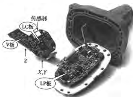
图3 数字三分量检波器内部部件图
