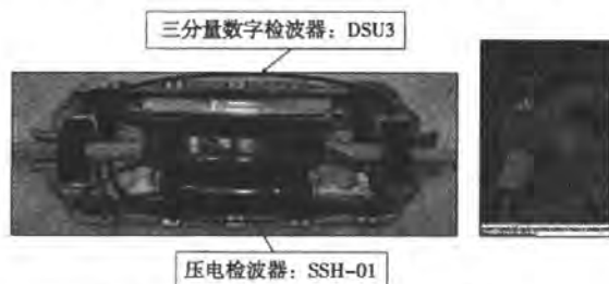
图 9 SeaRay 428 型接收点内部结构
